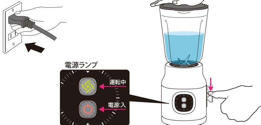
**禁止** 運転中にミキサーコップふたを開けたり、ミキサーコップの中に指やスプーン・はしなどの食材以外のものは入れない。けが・故障・破損のおそれがあります。
